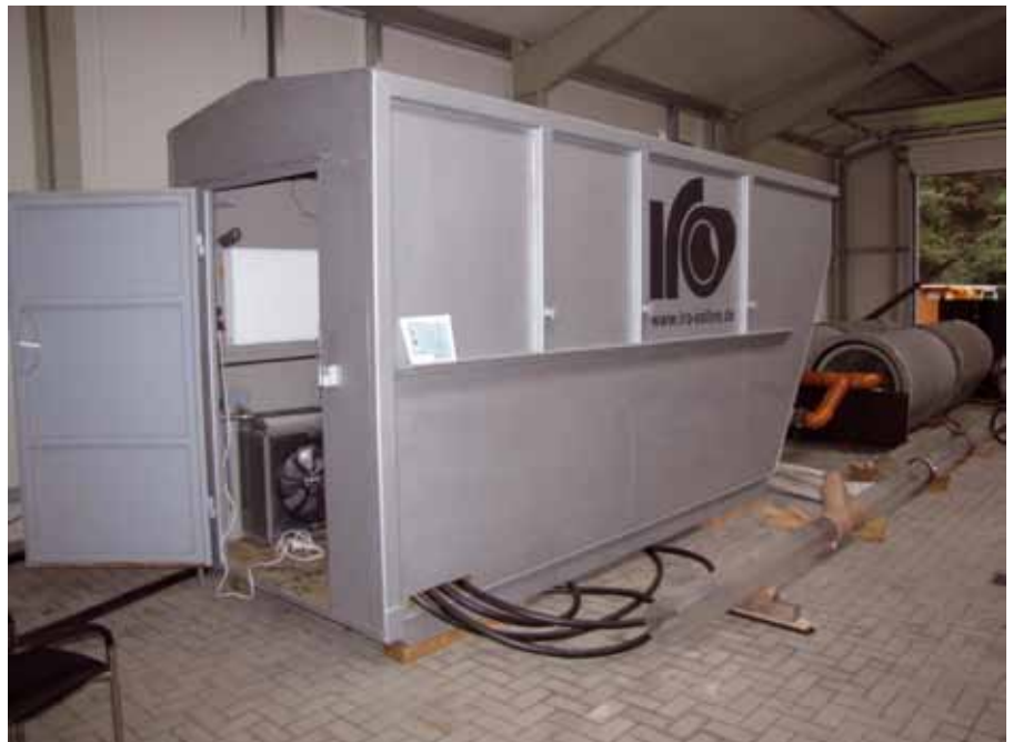
Abbildung 3: Mobiler Messcontainer zur Ermittlung der Wärmeleistung
