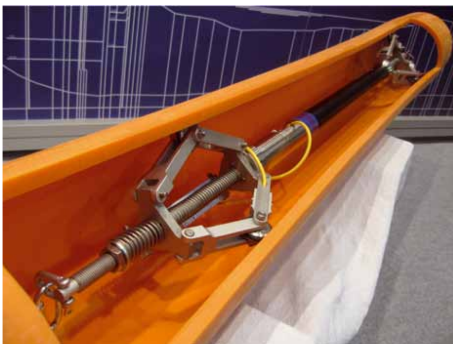
Beispiel eines Gerätes zur dreidimensionalen Erfassung des Verlaufes von Rohrleitungen (hier: DuctRunner™-HDD-4.2 der Reduct N.V.) [Quelle: ECB GEO PROJECT GmbH]
