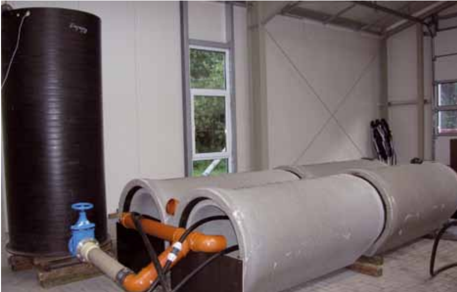
Abbildung 1: Versuchsaufbau mit Trägerrohren und Hochbehälter
