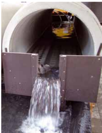
Abbildung 2: Dynamische Einstauvorrichtung zur Simulation unterschiedlicher Kanalbetriebszustände
