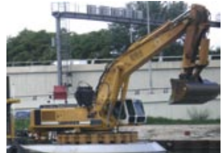
Obiges Bild zeigt einen Stelzenbagger
